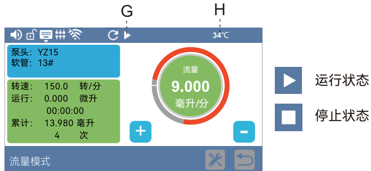
图10 泵顺时针运转运行时
