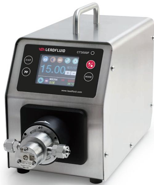
CT3000F采用伺服无刷电机驱动，高性能，低噪音，不锈钢磁驱动泵头，可实现无脉动，恒流速的流体控制。彩色液晶显示，触摸屏操作，可轻松设置参数。多种工作模式可选，流量显示，适用于各种实验领域。多种外控方式，方便与其他设备配合使用，支持Modbus通讯协议，简化系统开发的难度。
